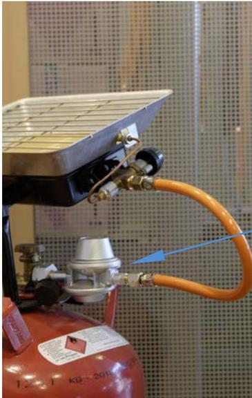
Druckregelgerät mit integrierter Überdrucksicherheitseinrichtung
