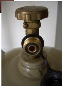
Nach der Herstellung der Anschlussverbindung (Absperrventil/Druckregelgerät bzw. Absperrventil/Hochdruckschlauch) muss diese vorsichtig bei geöffnetem Flüssiggasflaschen-Absperrventil und geschlossener Geräteabsperrrammer auf Dichtheit geprüft werden. Die Dichtheitsprüfung ist unter Betriebsdruck mit einem schaumbildenden Mittel (z. B. Lecksuchspray) durchzuführen, Abb. 17. Betriebsdruck besteht bei geöffnetem Absperrventil der Flüssiggasflasche und geschlossener Absperrrammer des Gasgerätes.
