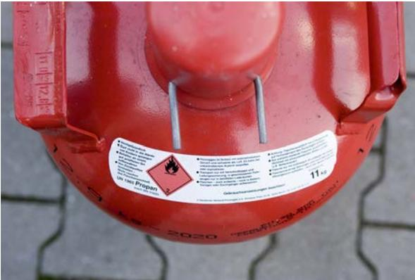
Abb. 52: Kennzeichnung Flüssiggasflasche (Gefahrgutaufkleber)
